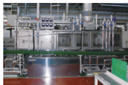
▲機械加工部品の洗浄ライン全体構成 様々な洗浄工程に分かれている
