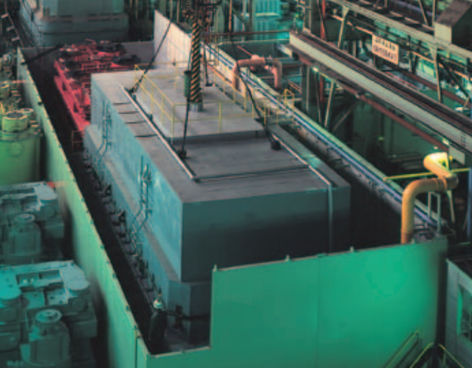
写真 7 巻線の単体前締め乾燥処理
