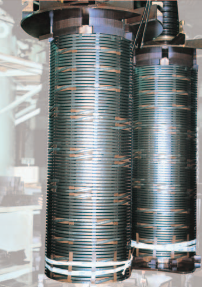
写真 7 巻線の単体前締め乾燥処理
