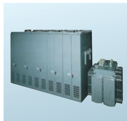
▲大容量任意波形出力電源 入力：三相, 6.6kV, 60Hz 出力：±50V, 10,000A
