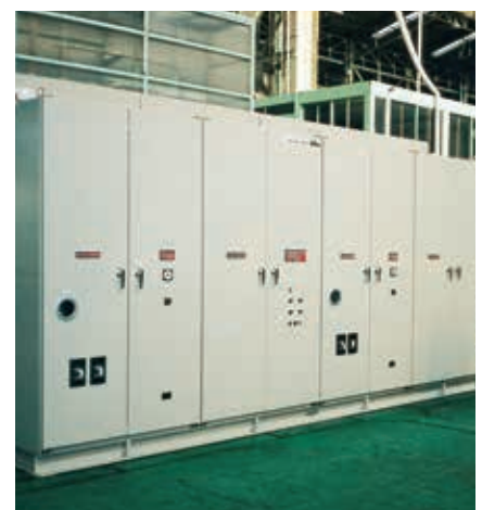
▲灰溶融用サイリスタ整流装置 入力：三相、6.6kV、60Hz 出力：DC 585V、4,500A
