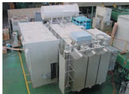
▲電解用直流電源装置(整流器横置き形) 入力：三相 22kV 60Hz 出力：DC 35V, 35,000A
