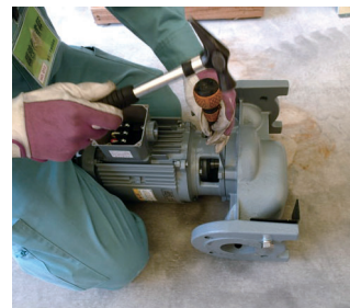
内蔵インバーターポンプ 分解メンテナンス
