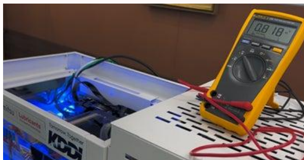
STCの放電能力の回復を電圧にて確認
