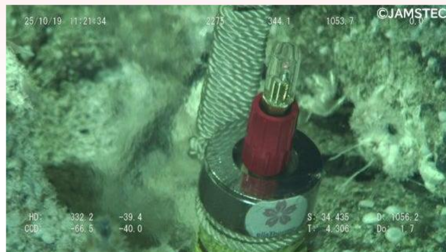
海底のSTCがLEDを点灯させる様子
