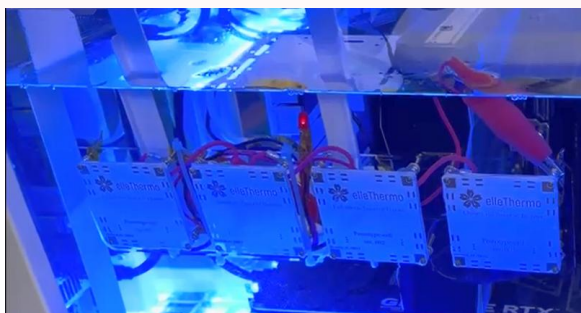
液浸冷却油中のSTCがLEDを点灯させる様子
