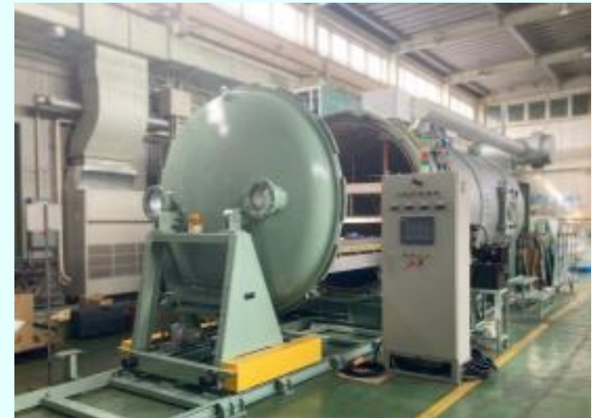
例: 紡糸減圧乾燥(平行平板電極)
